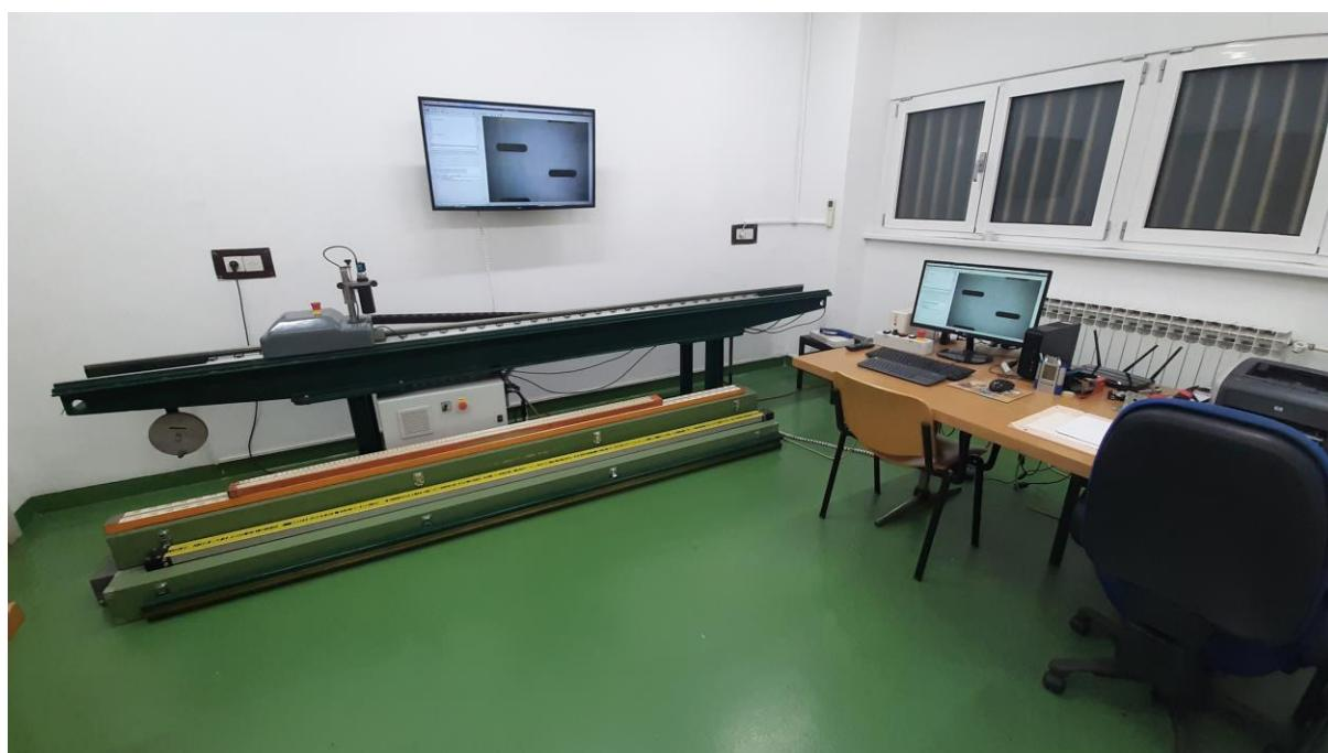
Slika 16. Automatizirani komparator za invarne nivelmanske letve.
