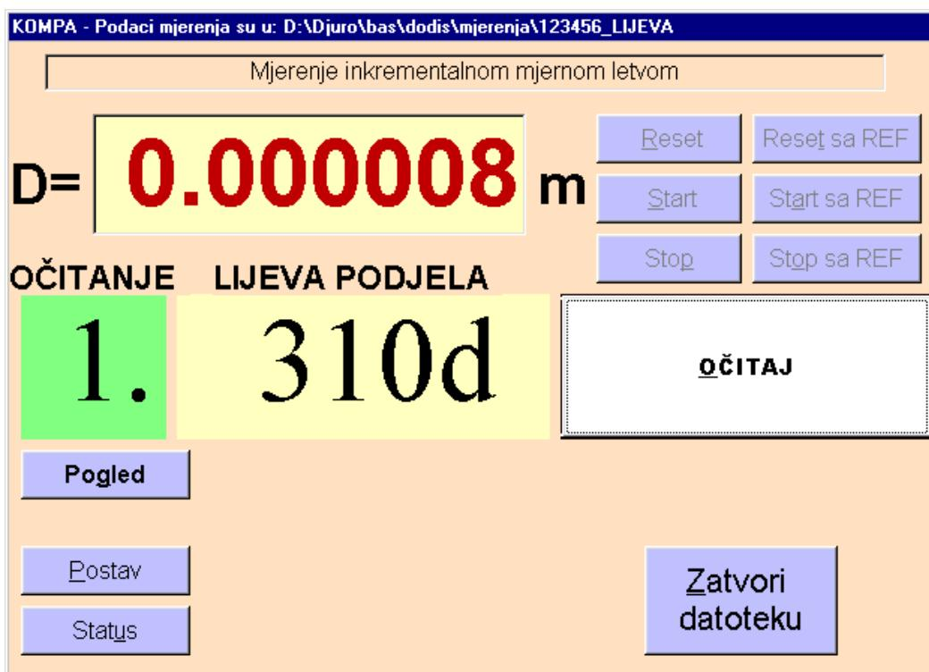
Slika 12. Program za umjeravanje nivelmanskih letvi i mjernih vrpci.
