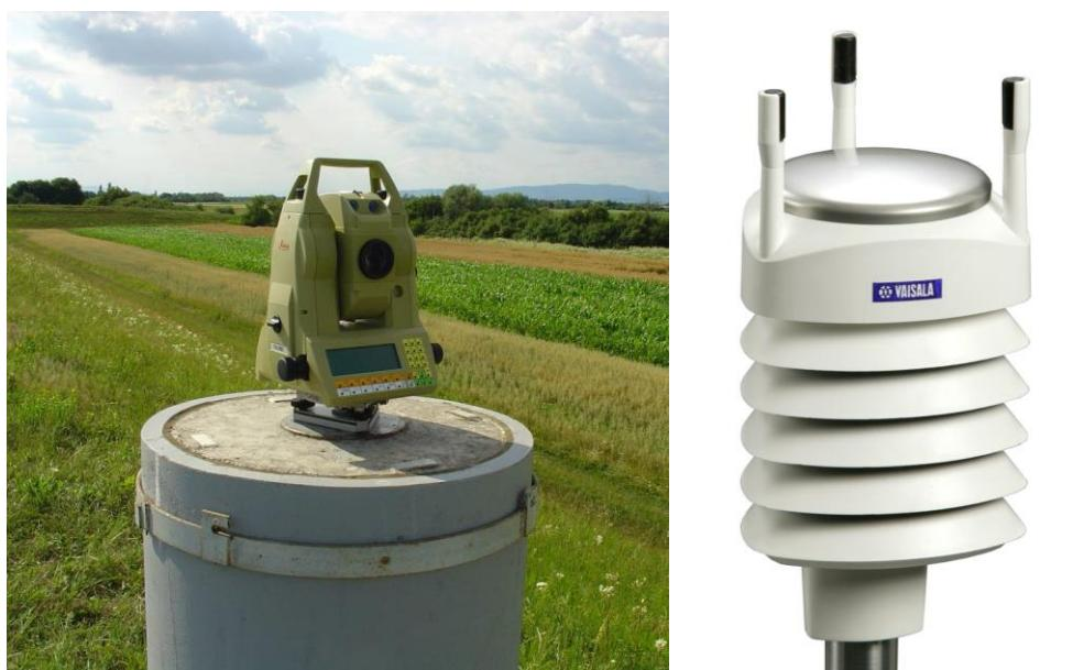
Slika 13. Precizni elektronički tahimetar Leica TCA2003 na kalibracijskoj bazi i meteorološka stanica Väisälä WXT510.
