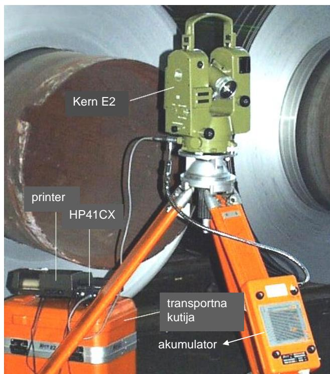
Slika 10. Automatizirano određivanje paralelnosti valjaka u TLM Šibenik.
