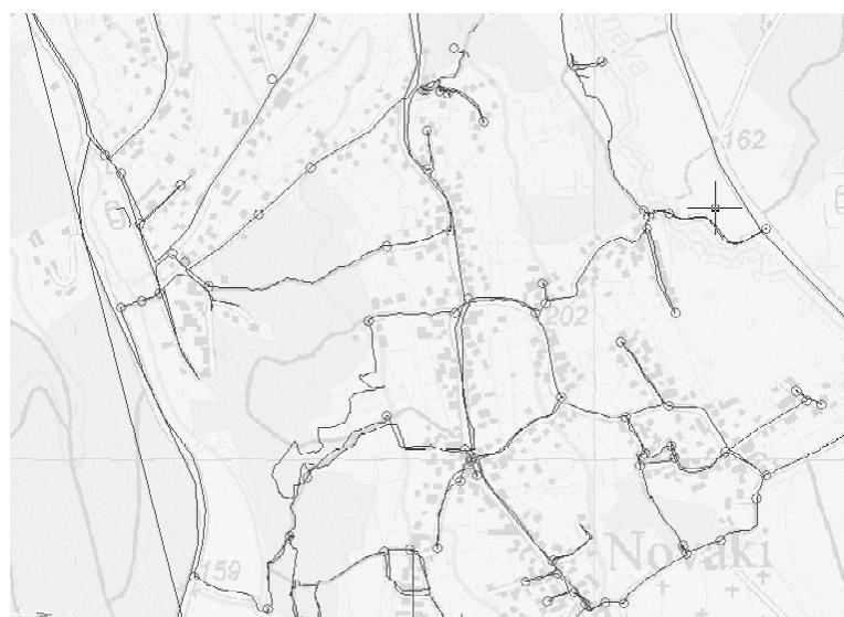
Slika 7. Kontrola mjereneih podataka i usporedba s topografskom kartom mjerila 1:25 000 (povećani detalj, kružići prikazuju markantne točke snimanja)
