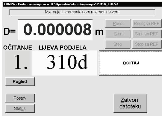
Slika 12. Program za umjeravanje nivelmanskih letvi i mjernih vrpci.
