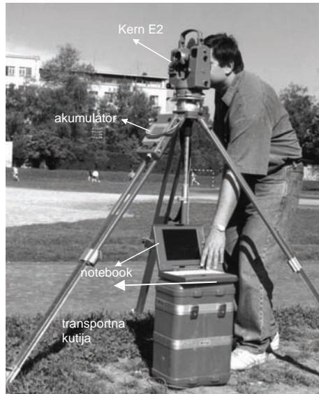
Slika 6. Automatizirano određivanje deformacija građevinskih objekata pri probnim opterećenjima.
