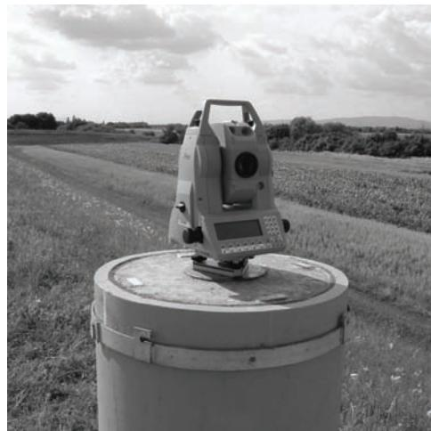
Slika 13. Precizni elektronički tahimetar Leica TCA2003 na kalibracijskoj bazi.
