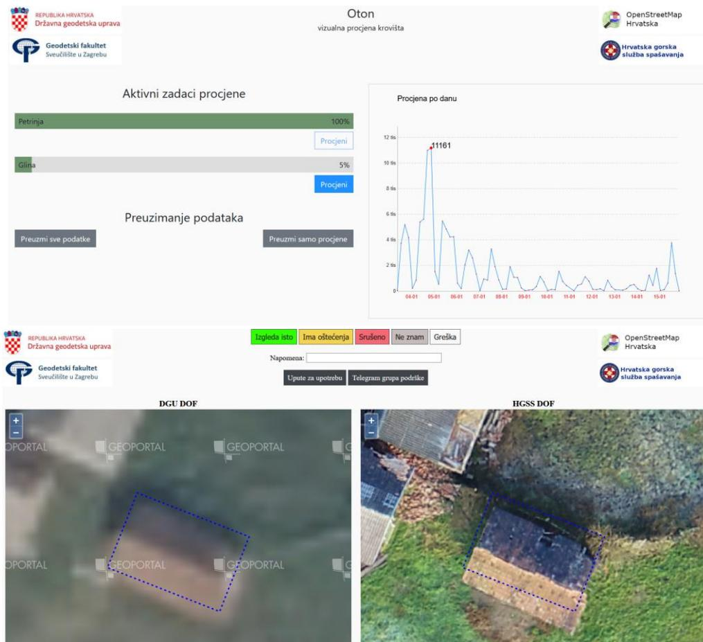
OTON aplikacija – Usporedba prepotresnog digitalnog ortofota (DGU) i aktualnog ortofota (HGSS)
