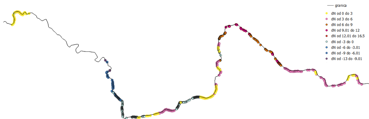
Slika 89. Grafički prikaz odstupanja po osi N (u metrima) baziran na 1026 identičnih točaka na „starom“ i „novom“ DKP-u.
