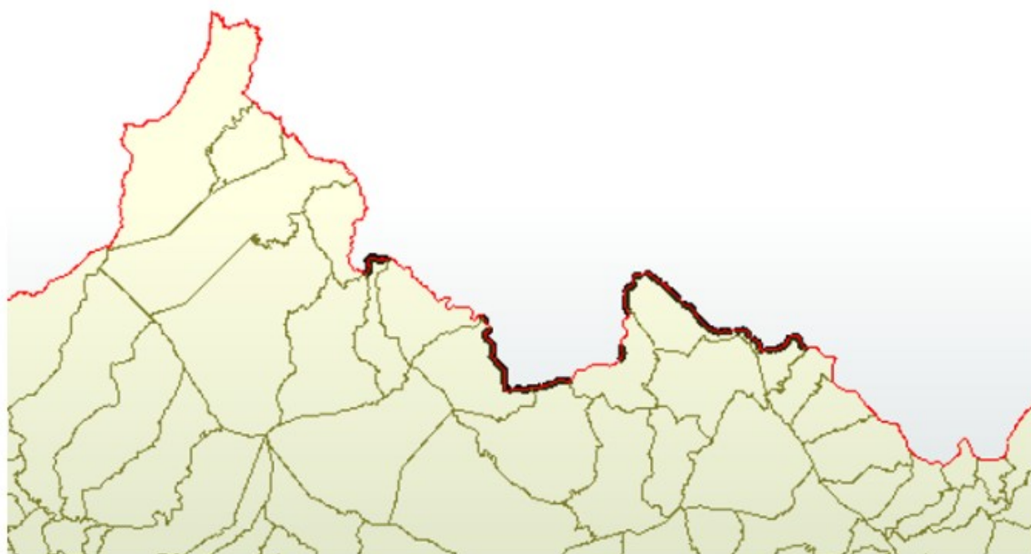
Slika 85. Prikaz područja identičnih točaka uzetih na „starom“ i „novom“ DKP-u u blizini granice katastarske općine za susjednom državom.
