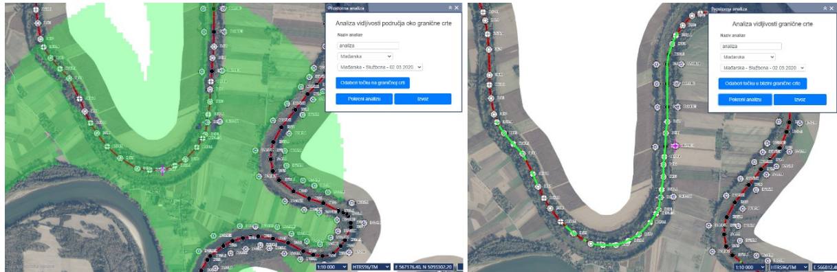
Slika 112. Prikaz analiza vidljivosti graničnog područja, oko područja granične crte (lijevo) te analiza vidljivosti granične crte (desno) (Triplat Horvat i dr. 2022).
