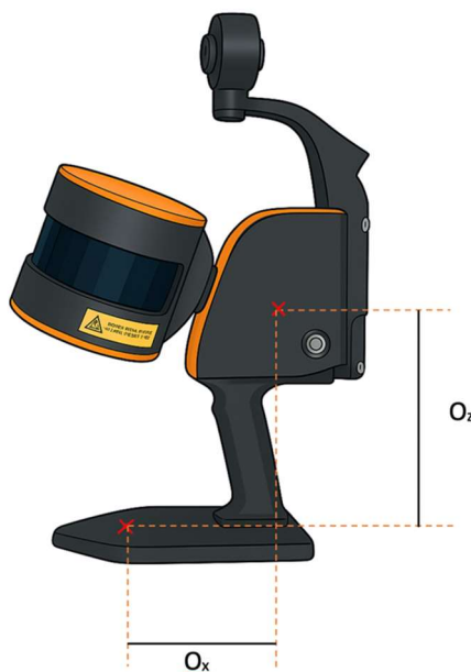
Slika 5.7. Prikaz položajnih odmakâ između referentne točke mobilnog sustava i referentne točke ploče za georeferenciranje
