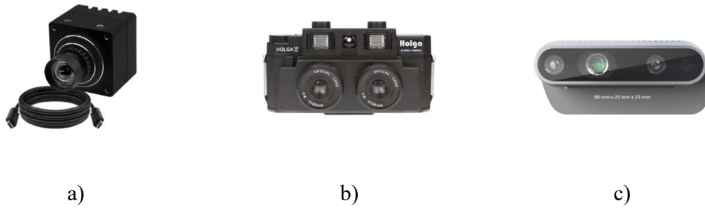
Slika 2.1. Primjeri različitih vrsta kamera: a) monokularne ( URL 1 ), b) stereo ( URL 2 ) i c) RGB-D ( URL 3 )
