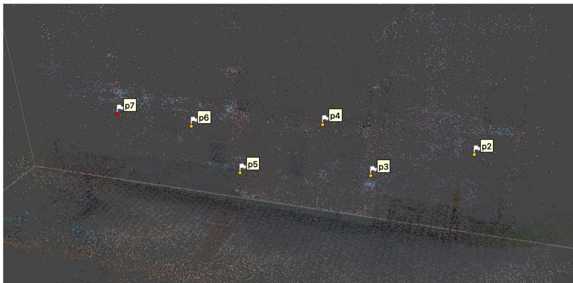
Slika 5.16. Automatski detektirane mjerne mete, povezane sa korespondentnim koordinatama u Agisoft Metashape programu. Mete su označene tzv. markerima te prikazane zajedno sa veznim točkama
