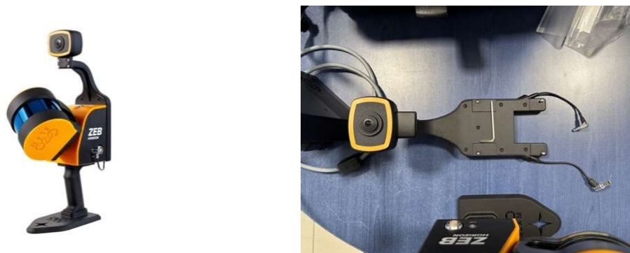
Slika 6.2. GeoSLAM ZEB-Vision kamera prije (desno) i nakon postavljanja na GeoSLAM ZEB-Horizon mobilni sustav (lijevo) ( URL 8 )
