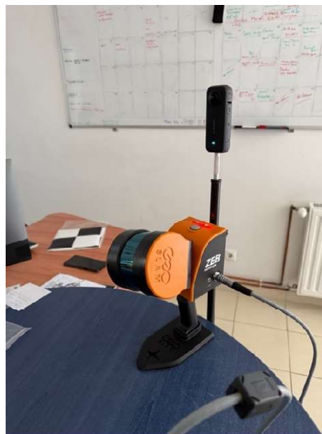
Slika 6.3. Prikaz nosača izrađenog za postavljanje Insta360 kamere na ZEB-Horizon
