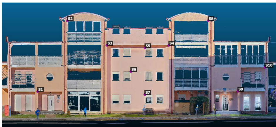
Slika 6.10. Prikaz položaja dvaju stajališta instrumenta te točaka mreže tvrtke Geo-centar korištene za orijentaciju mjerne stanice metodom kombiniranog presjeka
