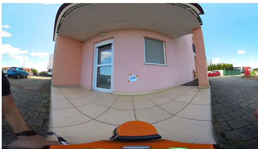
Slika 5.2. Segment panoramske slike dobivene razdvajanjem panoramskog videozapisa na zasebne sličice. Snimak prikazuje mjernu metu postavljenu u neposrednoj blizini ručnog mobilnog sustava, a koja se koristi kako bi se detektirao inicijalni mikro-pomak kamere
