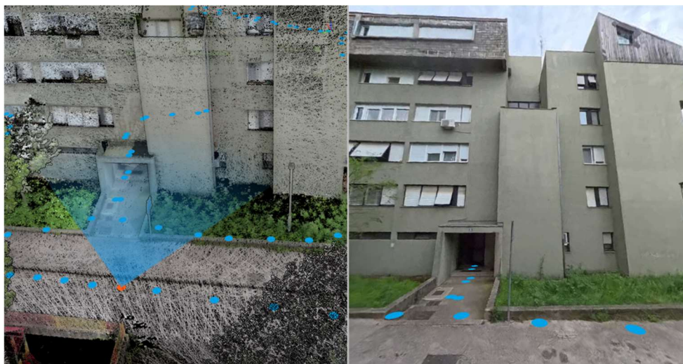
Slika 4.2. Prikaz oblaka točaka (lijevo) i korespondentne panoramske fotografije (desno), uz intuitivan prikaz smjernog kuta kamere
